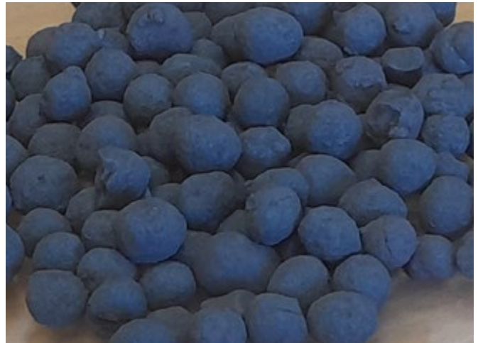
MEP2 기술을 사용하여 더치스 남부 드릴 코어에서 생산된 DR 자철석 정광(<2% 실리카)으로 만든 직접환원(DR) 펠릿 (소규모 테스트) 배치.
